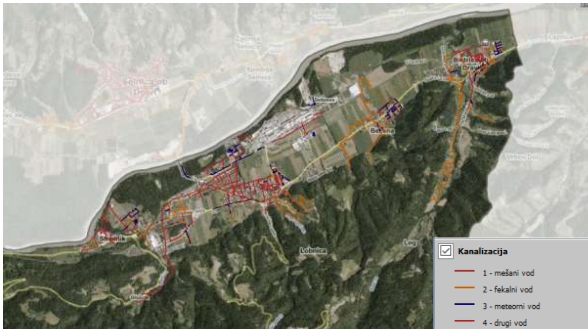
Slika 3: Kanalizacijsko omrežje v Občini Ruše
